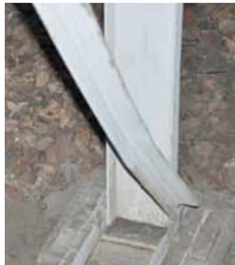
**Figura 60.** Fisura en perfil estructura de soporte correa transportadora
