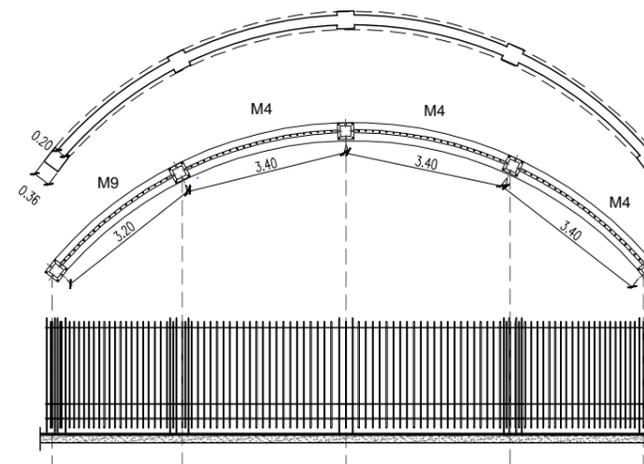
NOTA: Se respetará de manera constante, la altura superior de la reja en todo el perímetro, salvando el desnivel existente con ajustes en el zócalo de hormigón inferior considerando un mínimo de 0.20 m de alto y un máximo de 0.30 m de alto. Luego del replanteo general, la empresa Contratista realizará el detalle del Encuentro de la Reja con el Muro del edificio, para ser sometido a la aprobación de la inspección de obra.
