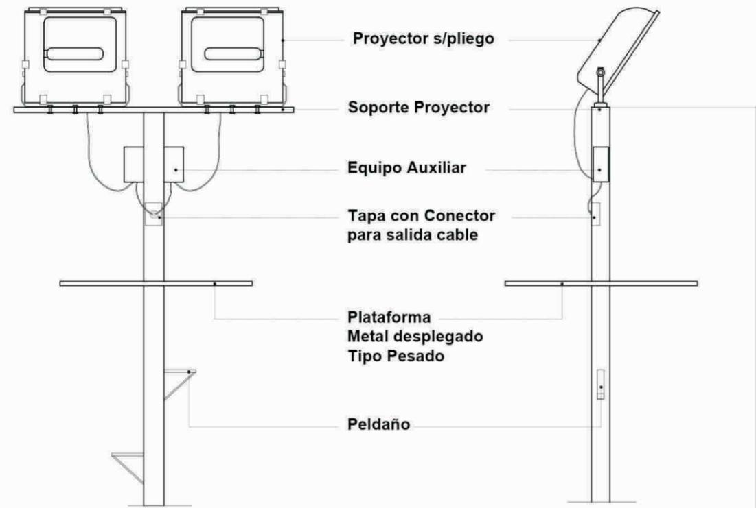
Nota: En los casos donde el municipio cuente con equipamiento específico para el mantenimiento del alumbrado, la inspección podrá descartar la implementación del peldaño y plataforma, resolución a fin de evitar posibles acciones vandálicas.
