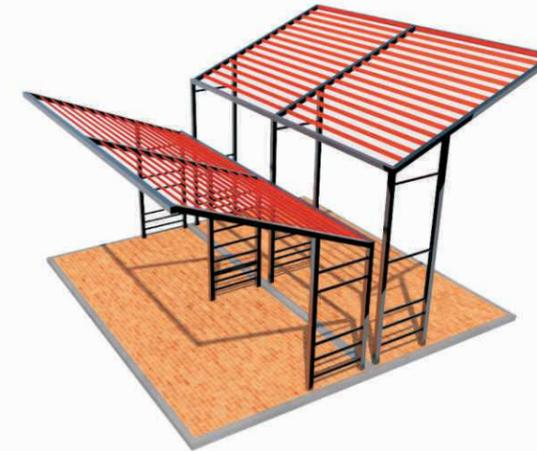
Se deberán prever los orificios en los módulos de piso, para las bases de anclaje de las pérgolas, las cuales serán llenadas en el momento de colocación de las mismas.
