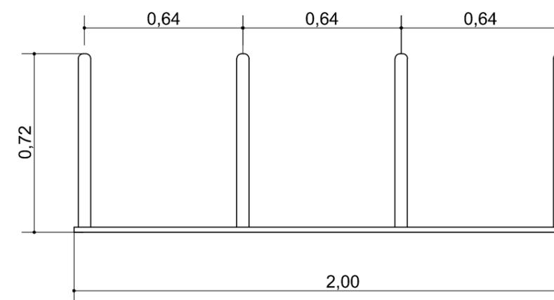
4 módulos formados por tubos estructurales de 2" curvado en forma de U. Fijación al suelo mediante una lamina metálica de calibre 12 con proceso mecanizado de plegado de 80 x 20mm. Perforaciones de 10mm para amurar al suelo. Terminación galvanizada en caliente.
