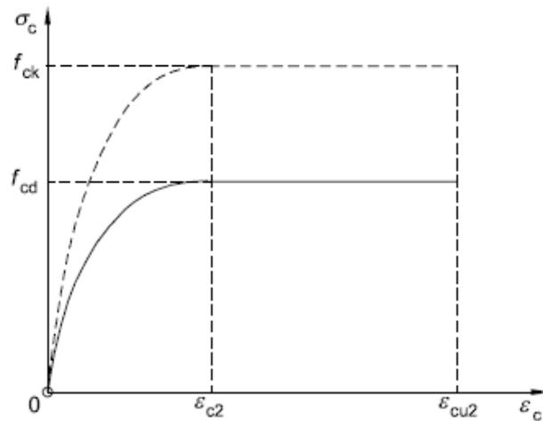
Figura 3.3 : Diagramas de cálculo tensión/deformación del hormigón.
