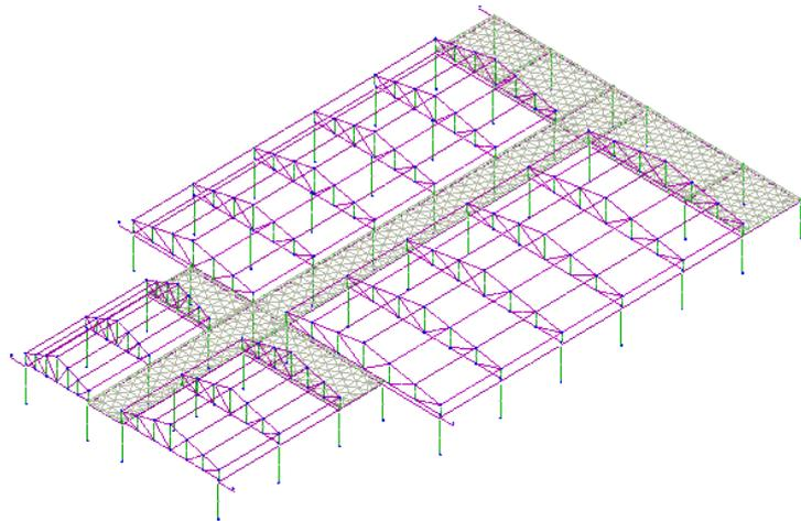
De las ilustraciones precedentes se deduce como las barra, sean vigas que pilares, están esquematizadas con un tramo flexible central y con dos tramos (brazos) rígidos en las extremidades. Los nudos vienen posicionados sobre el eje vertical de los pilares, en correspondencia del extradós de la viga más alta a la que se unen. A través de bracetos los tramos flexibles son conectados a ello.
