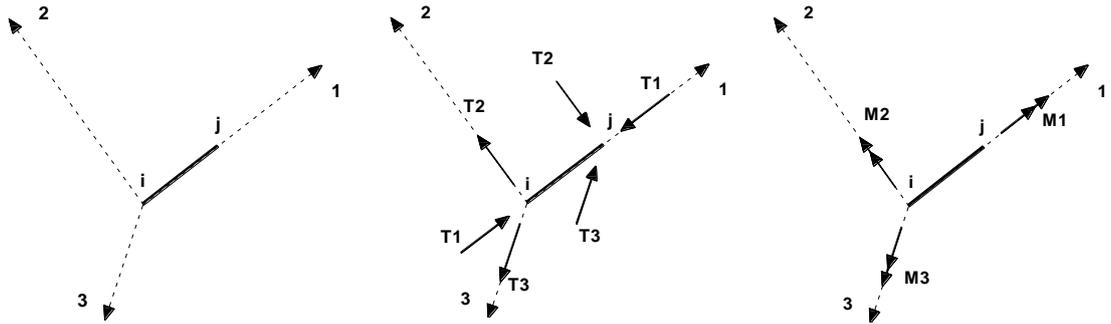
El elemento Viga es un clásico elemento estructural en grado de recibir Cargas distribuidas y Cargas Nodales aplicadas a los dos nudos de extremidad; por efecto de tales cargas nacen, en los extremos, solicitaciones de corte, esfuerzo normal, momentos flexionante y torsionante.
