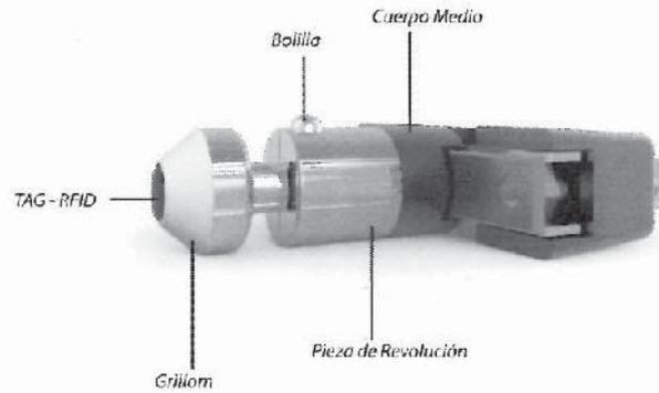
Es la parte del perno que debe servir de nexo entre la puntera y el soporte de sujeción de la bicicleta. Deberá ser una pieza sólida de acero, preferiblemente SAE12L14.
