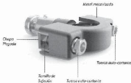
Su función será la de acoplar el perno de anclaje a la bicicleta y fijarlo por un tiempo indeterminado. Esta pieza deberá estar constituida por una abrazadera, de chapa 1010 doble decapado, sólida, sujeta a la bicicleta con 2 tornillos de sujeción y 2 tuercas de acero anti vandálicas.
