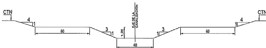
De acuerdo con ello se definió, un cauce menor de modo de contar con una capacidad de conducción suficiente como para conducir los caudales mínimos para el estiaje, en condiciones que faciliten su mantenimiento.
